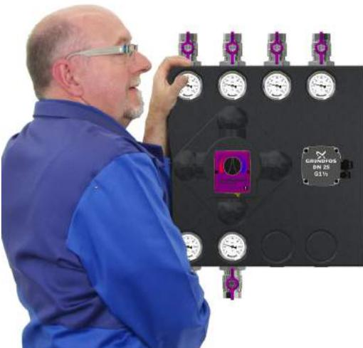
Die Thermometer werden jetzt in die Messing-Hülsen eingesteckt und ausgerichtet. Notfalls können die Zungen der Hülse mit einer Spitzzange nachgespannt werden.
