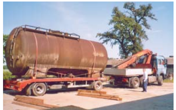
Vor dem Verschrotten gerettet: Ein ausrangierter Kesselwaggon der ÖBB wurde zum Solarspeicher umgebaut.
